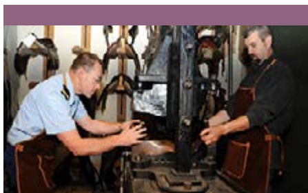
La presse permet le moulage à chaud des sièges de cavalerie.
