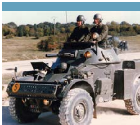
Automitrailleuse légère (AML) Panhard avec canon de 90 mm.
